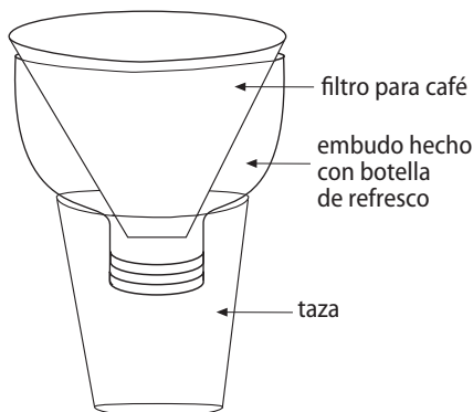
Ejemplo de medio de filtración
